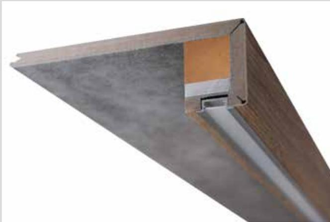
Bei der Vorbereitung für die LED Leisten wird das Element 2x gekantet und in der Unterkante wird die LED Leiste eingesetzt. Hier können Sie zwischen dem Typ C-1 und C-2 wählen. Die Höhe (Innenmaß) kann auf Wunsch gefertigt werden. Bei der Unterkante (Innenmaß) muss das Maß mind. 35 mm betragen.
